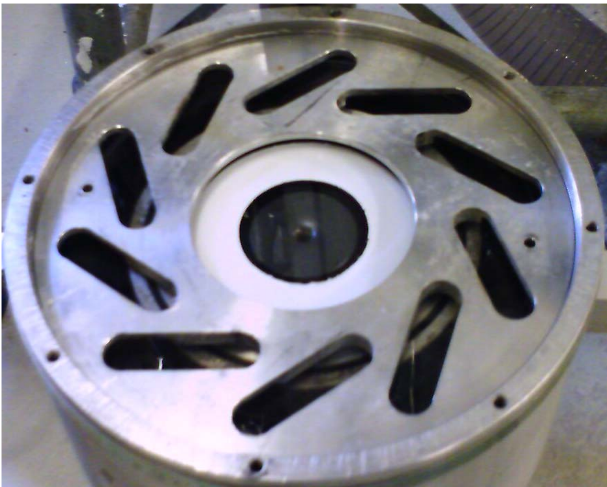
Abb. 30: Einspannung des Messfenster mit Aussparungen für Halogenlampen
